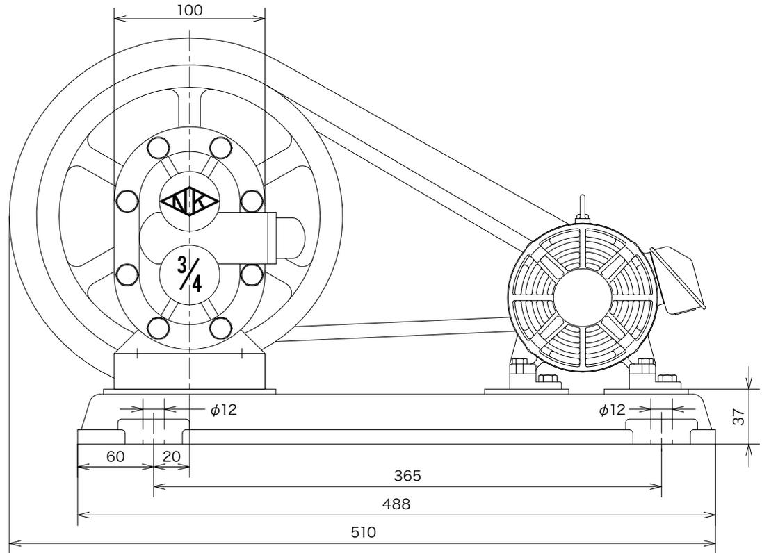
ポンプ側Vプーリ (P.P) 8×A1 / モーター側Vプーリ (M.P) 2×A1 / VベルトA 40 / モーター馬力 0.4kw
