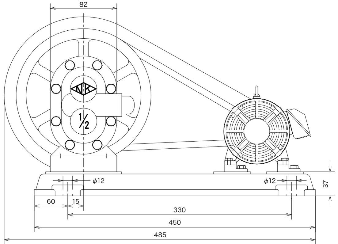
ポンプ側Vプーリ (P.P) 7×A1 / モーター側Vプーリ (M.P) 2×A1 / VベルトA 36 / モーター馬力 0.4kw
