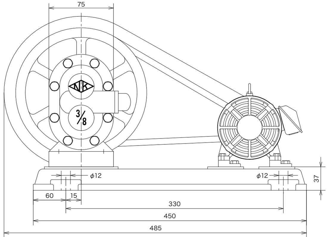
ポンプ側Vプーリ (P.P) 7×A1 / モーター側Vプーリ (M.P) 2×A1 / VベルトA 36 / モーター馬力 0.2kw
