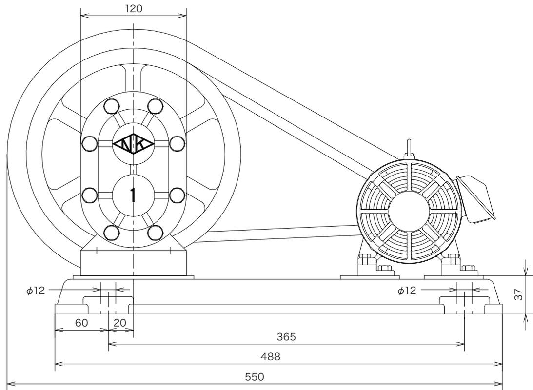
ポンプ側Vプーリ (P.P) 10×A2 / モーター側Vプーリ (M.P) 2 1/2×A2 / VベルトA 44 / モーター馬力 0.75kw
