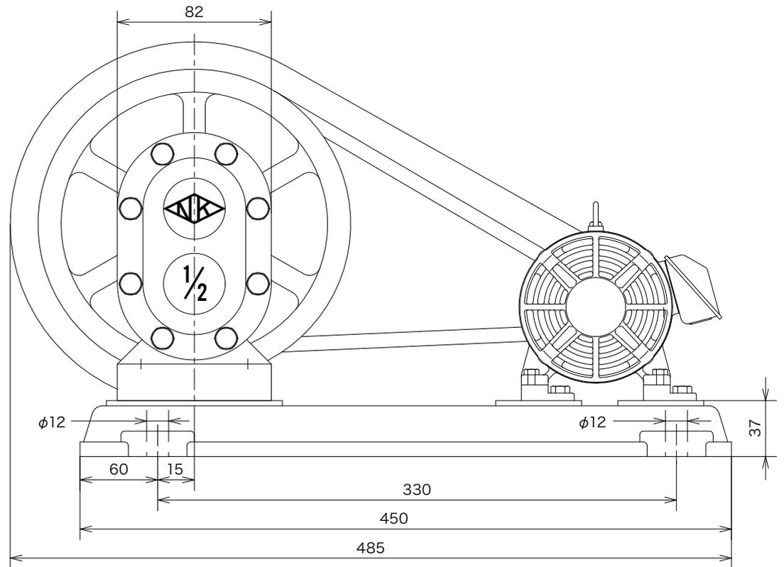
ポンプ側Vプーリ (P.P) 7×A1 / モーター側Vプーリ (M.P) 2×A1 / VベルトA 36 / モーター馬力 0.4kw
